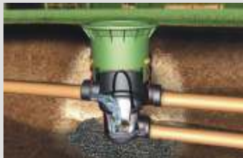
Universal-3 vanjski za površine do 500 m 2 fi 400 mm, v = 600-1050 mm spoj fi 110 ili 160 mm
