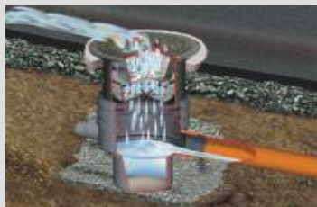
Šaht sa pjeskolovom i filterom za površine do 500 m 2 fi 400 mm, v = 570-1050 mm spoj fi 110 ili 160 mm
